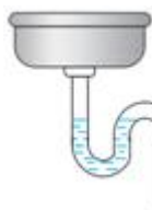
C. 下水道口存水管
