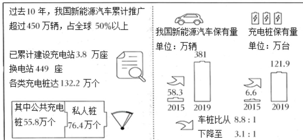
材料三：充电桩是新能源汽车行业发展的基石，充电桩之于电动车的意义，就好比加油站/加气站之于传统 ICE 化学燃料汽车的意义。按照充电方式的不同，充电桩可以分为直流充电桩和交流充电桩两种。直流充电桩也就是通常说的“快充”，能直接为动力电池充电。为直流充电桩可以实现快速充电，但同时也存在成本高，一般在交流桩的 10 倍以上，且有对电池寿命不利的问题。交流充电桩俗称“慢充”，即不能直接为动力电池充电，需连接车载充电
