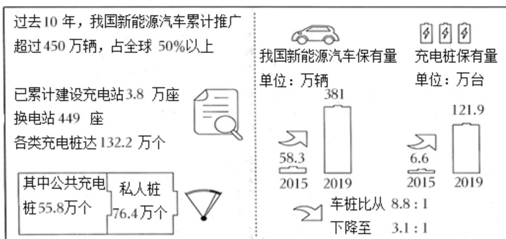
材料三：充电桩是新能源汽车行业发展的基石，充电桩之于电动车的意义，就好比加油站/加气站之于传统 ICE 化学燃料汽车的意义。按照充电方式的不同，充电桩可以分为直流充电桩和交流充电桩两种。直流充电桩也就是通常说的“快充”，能直接为动力电池充电。为直流充电桩可以实现快速充电，但同时也存在成本高，一般在交流桩的 10 倍以上，且有对电池寿命不利的问题。交流充电桩俗称“慢充”，即不能直接为动力电池充电，需连接车载充电机来充电。虽然交流充电桩功率小、充电慢，但成本低，电池寿命不受影响。这也是交流电桩多而直流充电桩较少，充电的速度较慢的原因。
