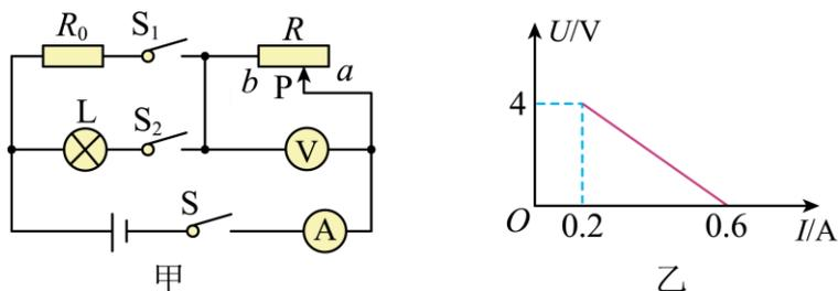
31. 综合实践活动中，同学们设计了一款可用电流表示数显示拉力大小的测力计模型，电流表示数随拉力的增大而增大。模型电路如图甲所示， $ab$  为长 10cm、阻值  $25\Omega$  的电阻丝，其阻值与长度成正比，滑片 P 左端固定在拉杆上，弹簧处于原长时，滑片 P 位于  $a$  端，电源电压恒为  $6V$ ，弹簧电阻恒为  $1\Omega$ ， $R_0$  为  $4\Omega$ ，其余部分电阻不计，电流表量程为  $0\sim 0.6A$ 。忽略弹簧、拉杆和拉环的重力及滑片与电阻丝的摩擦。
