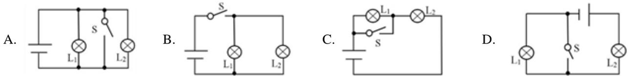
5. 小聪观察家里的冰箱，发现冰箱的灯在开冰箱门时亮，关冰箱门时灭；冰箱的压缩机则在需要制冷时才工作。关于冰箱里的灯和压缩机的连接方式，下列判断正确的是（ ）
